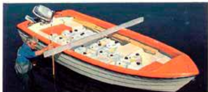
Fribordsmätning med belastning
